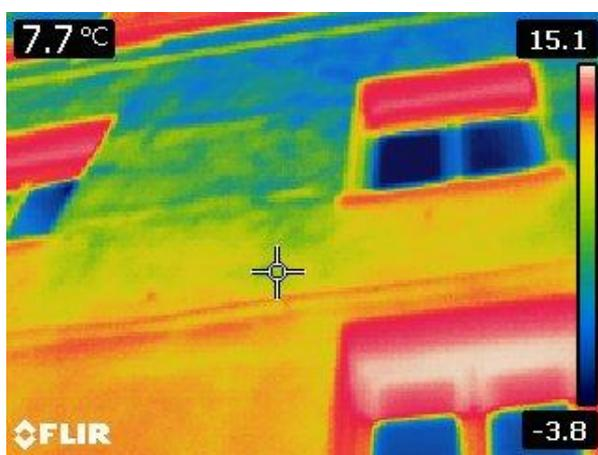
Figura 2.5 – Immagine termografica muro dall'esterno
